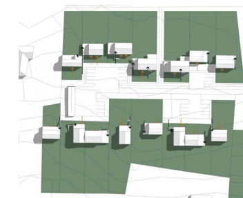
Des voies en impasse traitées comme des «cours habitées» gérant le stationnement. Eco-lotissement à Marsac du Lisles (33)
