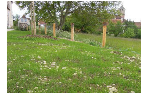
Mélange terre pierre enherbé : un revêtement simple et peu coûteux adapté à un stationnement complémentaire
